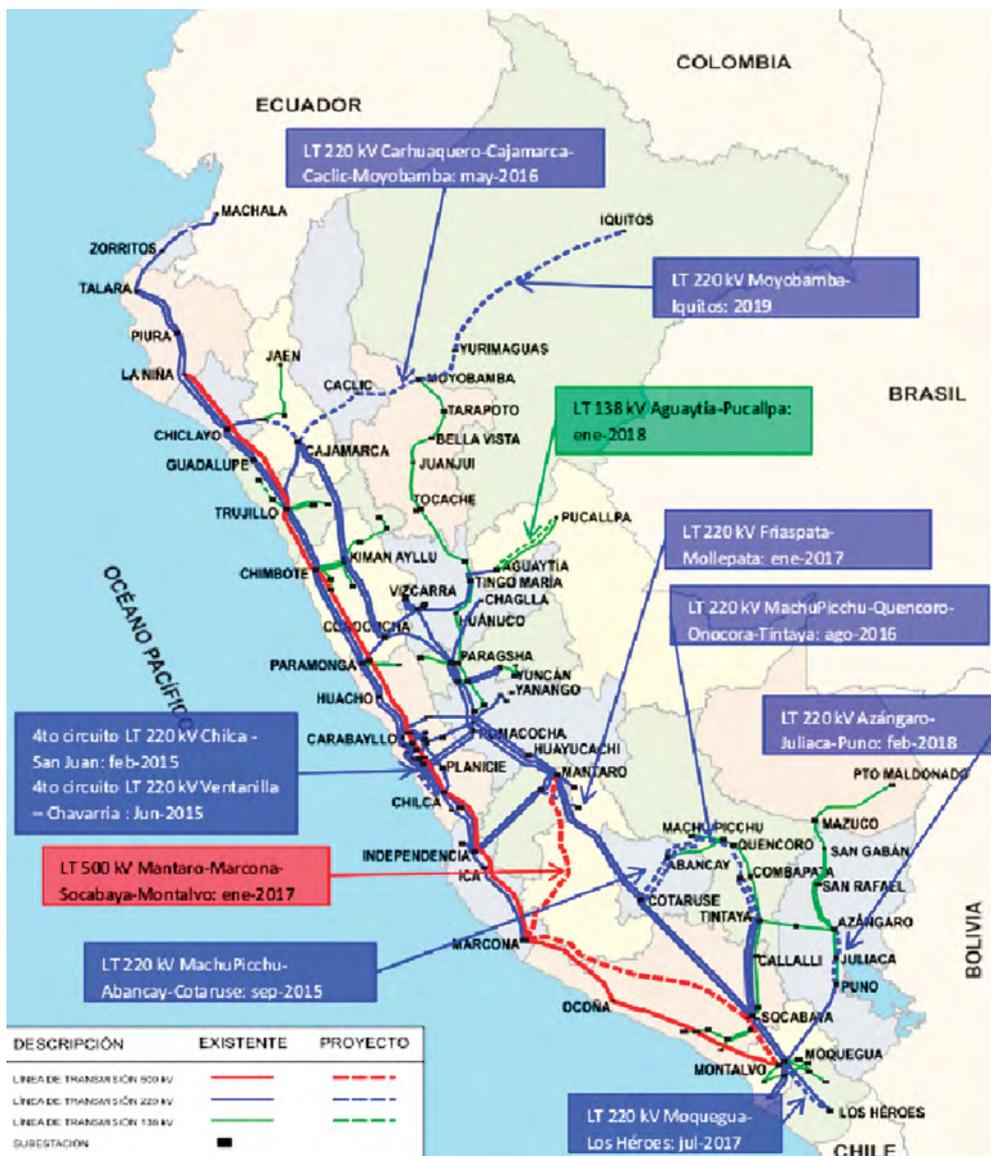
Figura 5.5: Mapa de líneas de transmisión eléctrica de 500 kV existentes y en proyecto del SEIN [37].
